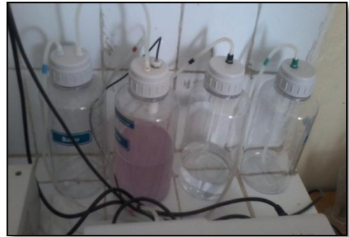
Figure 29: réservoir pour la solution de lavage.
